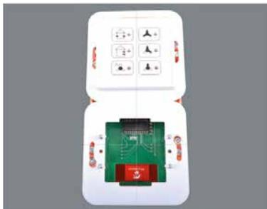
Das POLO-AIR ONE+ Bedienteil ist zur Montage in einer Doppelhohlwanddose konzipiert. Sie kann zur Ansteuerung von bis zu zehn POLO-AIR ONE+ Lüfterpaaren (20 Lüftungseinheiten) eingesetzt werden. Die POLO-AIR ONE+ Funkregelung ist als ortsfestes Betriebsmittel anzuschließen.
