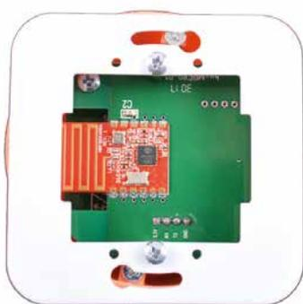
Nehmen Sie die Unterputzdose vorsichtig ab, um die Programmierung der Empfangseinheit vornehmen zu können. Schließen Sie nach der Programmierung die Steuerleitung zur Lüftungseinheit (12 V DC, min. 3 x 0,6 mm<sup>2</sup>) und die Stromversorgung für die Empfangseinheit (230 V AC, 3 x 1,5 mm<sup>2</sup>) an.
